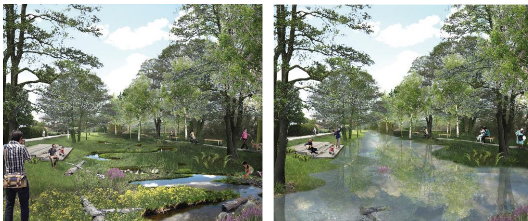
Figur 23. Typillustrationer som visar hur en och samma plats kan upplevas olika vid normalvattenstånd respektive högvatten. Ytorna gestaltas för att kunna svämma och fluktuationerna i vattenståndet bidrar till ökad biologisk mångfald – värden som ofta försvunnit i rätade och fördjupade vattendrag. Illustration: Ekologigruppen.
