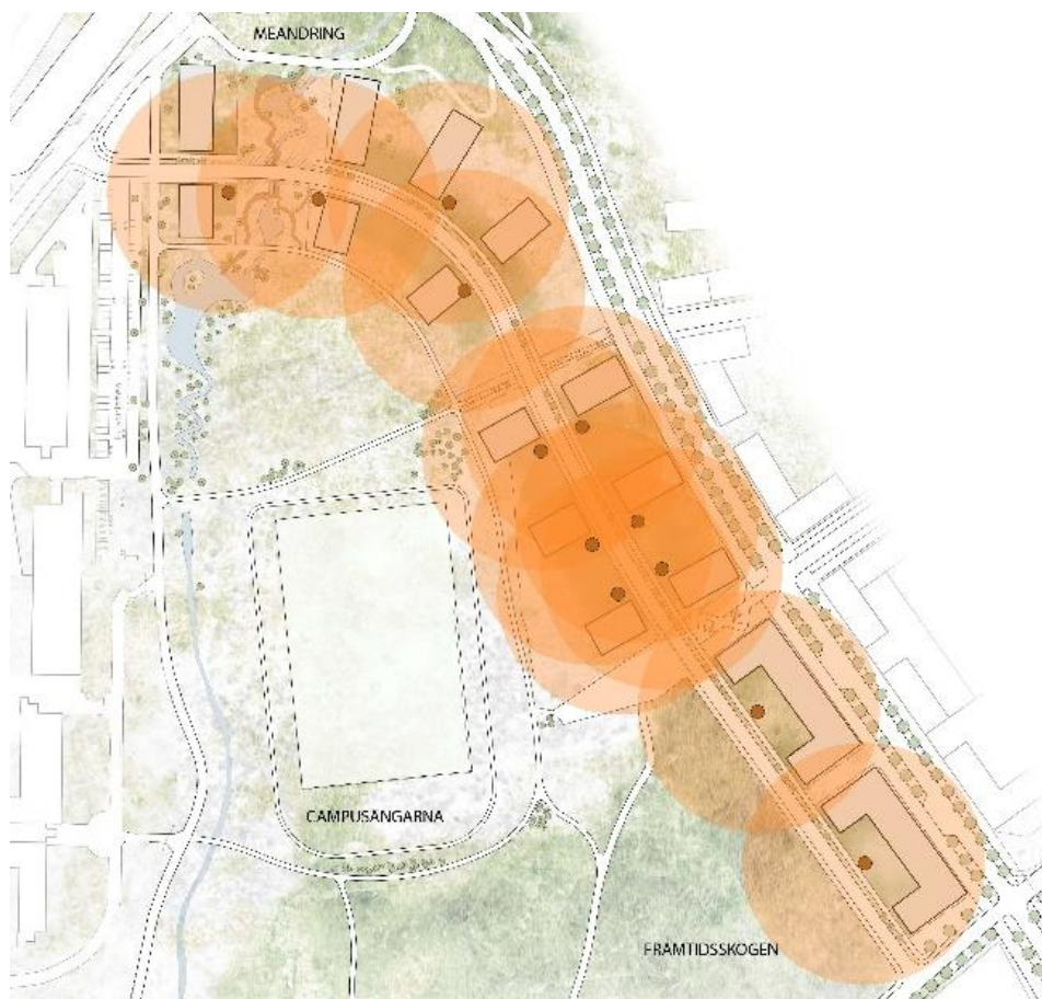
Figur 56. Illustrationen redovisar ett möjligt scenario för placering av avfallsbehållare. Orangea cirklar markerar ett avstånd om 100 meter i diameter – för att säkerställa att kravet om 50 meter till entréer är möjligt att uppfylla.
