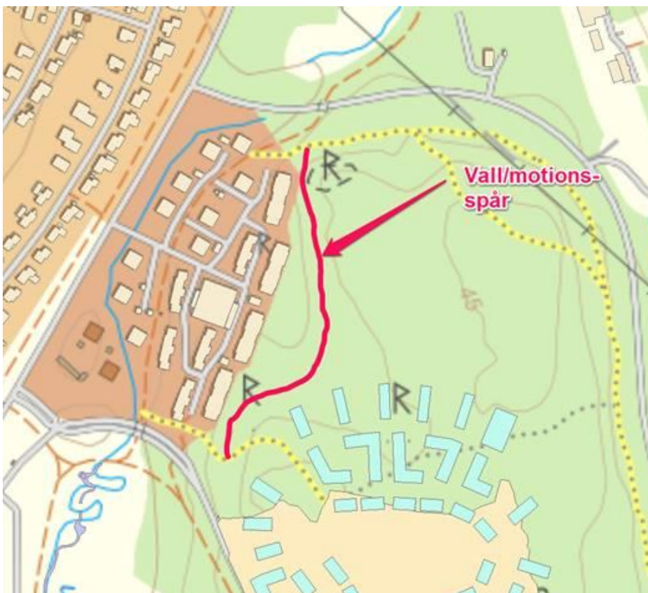
Figur 14. Förslag på magasinutformning genom att motionsspåret läggs på en vall.
