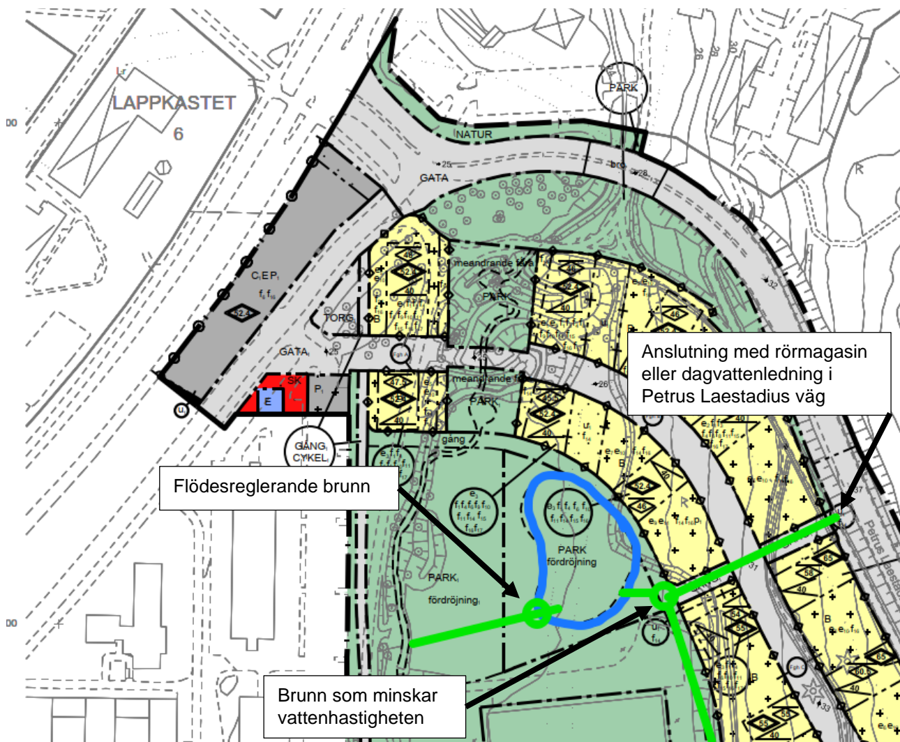
Figur 11. Principskiss för dagvattenmagasinet Bönan.
