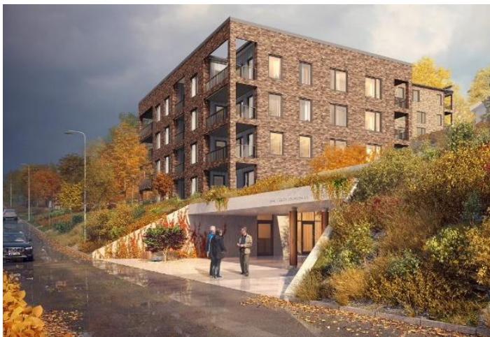
Figur 15. Exempelbild på hur nedgrävda cykelparkeringar kan uppföras med syfte att nyttja terrängen. Källa: Lindberg Stenberg arkitekter AB
