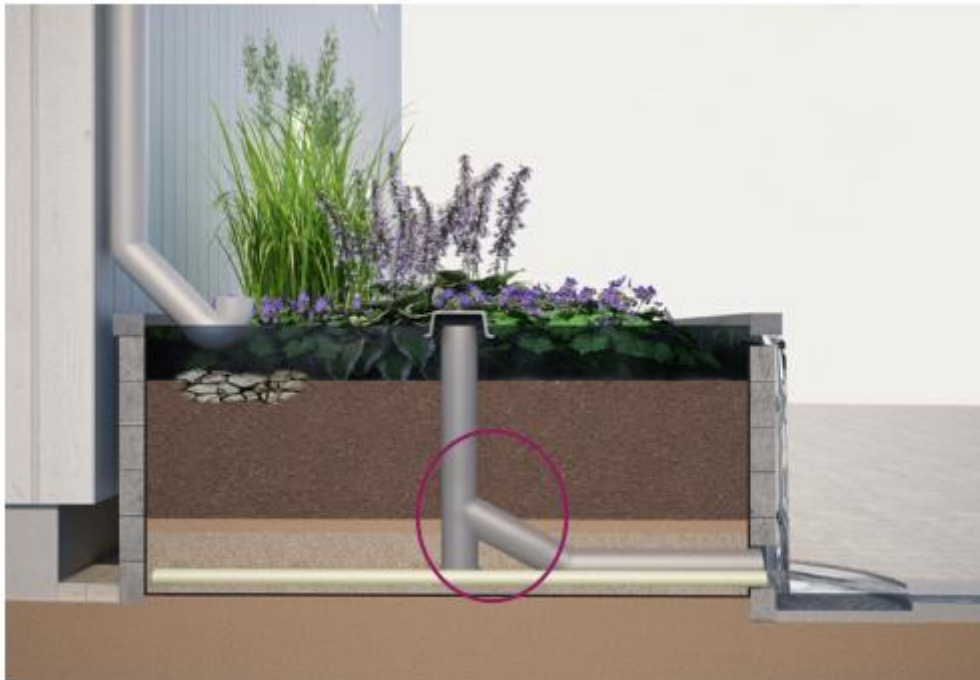
Figur 15. Regnbädd med vattenlås för att minska risken för rotinträngning och för att öka dess vattenhållande förmåga. Utlopp kan utföras underjordiskt eller ytligt. Regnbädd kan förses med tätskikt för att inte belasta fastighetens grundläggning med vatten. (SLU 2015)
