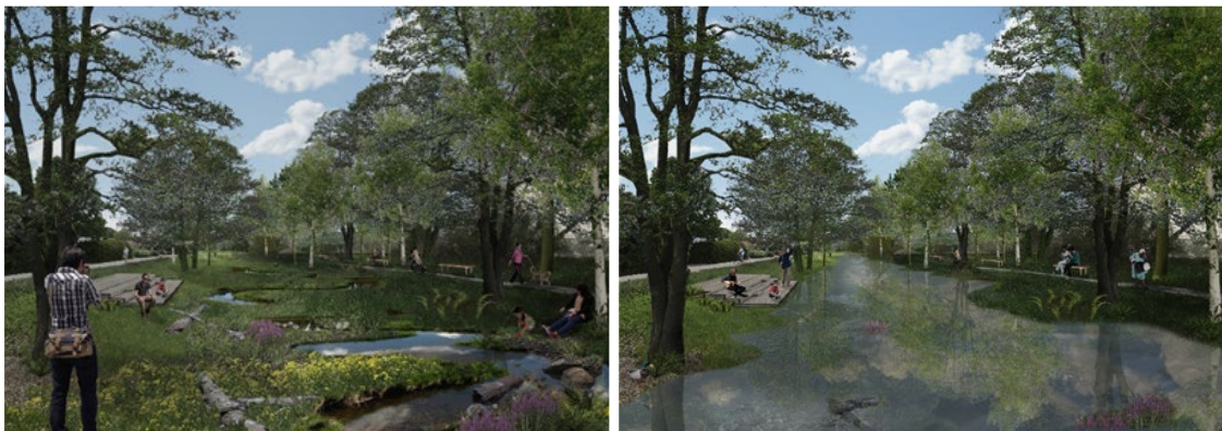
Typillustration som visar samma årum vid normala respektive höga flöden. Flacka slänter möjliggör för att vattendraget ska kunna svämma och skapar en naturlig fluktuation i vattenstånd. Samtidigt ökar rekreativvärdena på platsen i och med att variationen skapar ett föränderligt landskap som ser olika ut från dag till dag.
