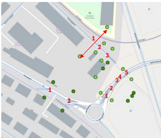
Figur 12 Illustration över receptorpunkter från beräkningen av nuläget 2023. I Kv Vippan finns befintliga byggnader och Kv Uttern är obebyggd. Befintliga byggnader är implementerade i Simair karta OpenStreetMap, som också innehåller dataset för byggnader.
