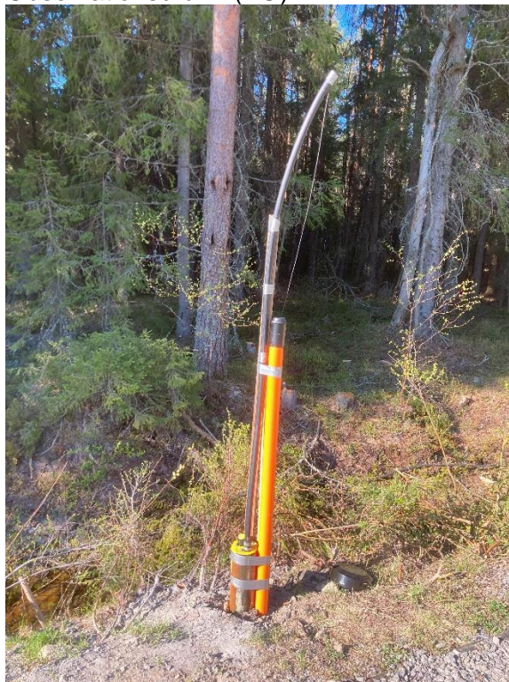
Figur 3. Huvudbrunn, reservbrunn och observationsbrunn med tillhörande utrustning. Observationsbrunnen förlängdes uppåt med PE-rör för att hantera artesiska förhållanden, för att kunna mäta grundvattennivå ovan markyta.
