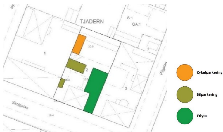
Figur 16. Illustration på ungefärliga placeringar av cykelparkering, bilparkering och sammanhängande friyta inom fastigheten.
