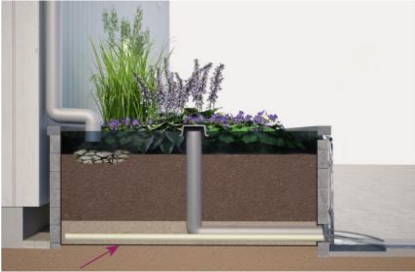
Figur 27. Principskiss över en regnbädds funktion i profil. Regnbädd "typ 4" med tät duk. Används lämpligen vid risk för att vattnet tar sig in till grunden. Bilden är tagen från Movium 2, 2015, illustration: Tengbomgruppen.
