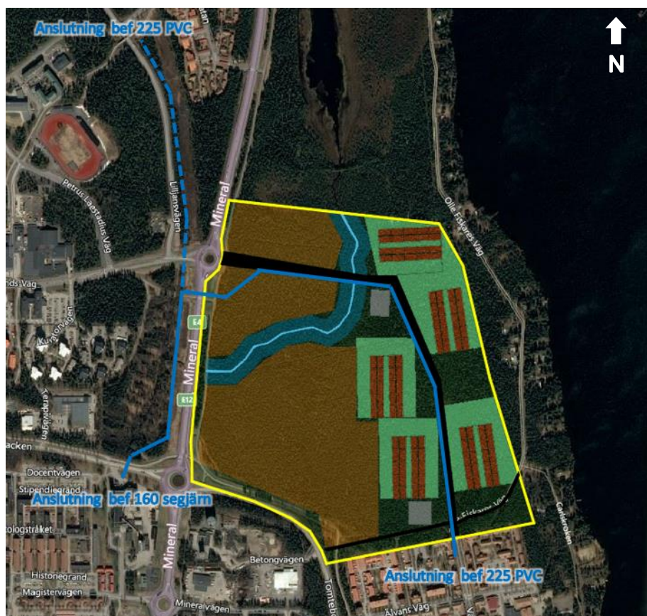
Figur 5. Schematisk skiss över dricksvattenförsörjning med rundmatning till området. Området får dels vatten söderifrån, från Tomtebo, och dels västerifrån. Förslagsvis används Ålidhemsavsättningen främst för anslutningen västerifrån, men den streckade sträckan visar att ledningar även kan dras till Olofsdals nät för att få ökad driftsäkerhet. Bildkälla bakgrundsbild: Bing 2018.
