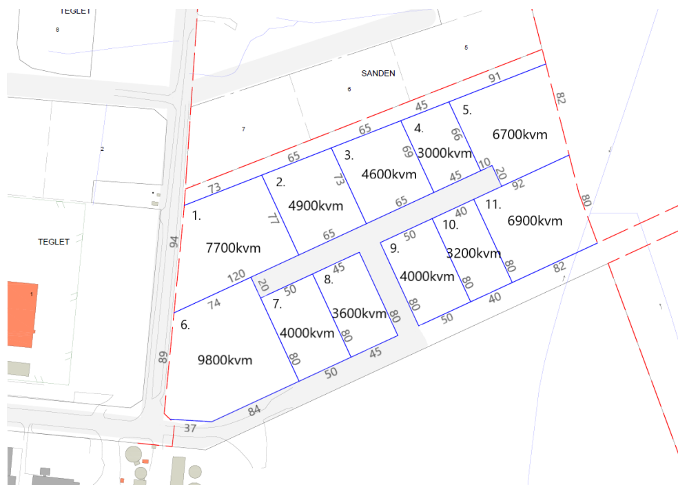
Figur 3. Preliminär fastighetsindelning med areal och mått på fastighetsgränserna. Blå streck visar preliminära fastighetsgränser. Observera att arealerna och måtten på gränserna endast är uppskattade eftersom förrättningen inte är genomförd ännu.
