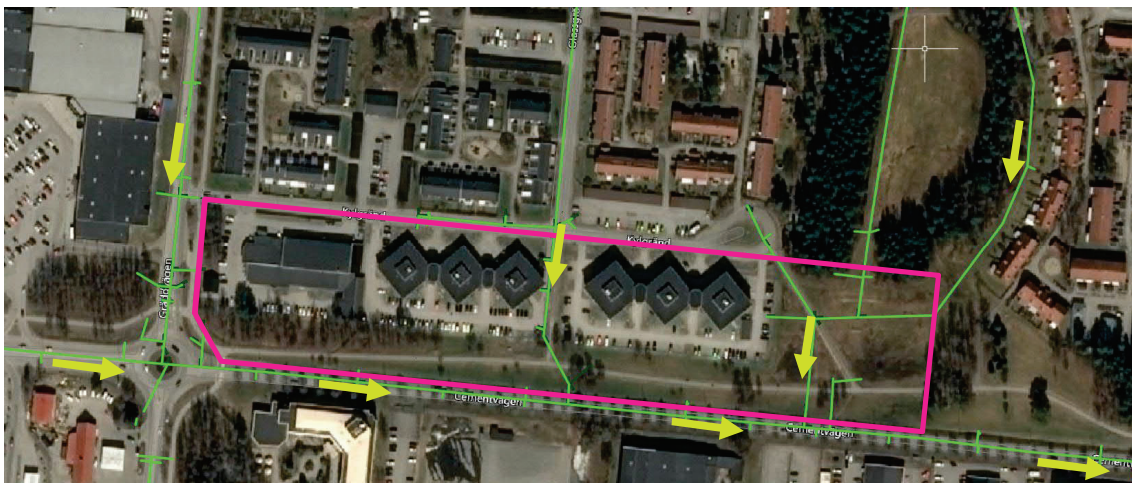
Figur 5. Pilar visar dagvattnets flödesriktning i ledningarna.
