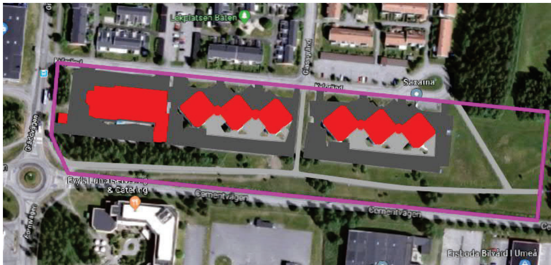
Figur 13. Befintliga ytor inom planområdet. Rött=tak, mörkgrått=parkering o körbara ytor, ljusgrått=övriga asfalt ytor (GC etc), Övriga ytor som grönt/parkmark
