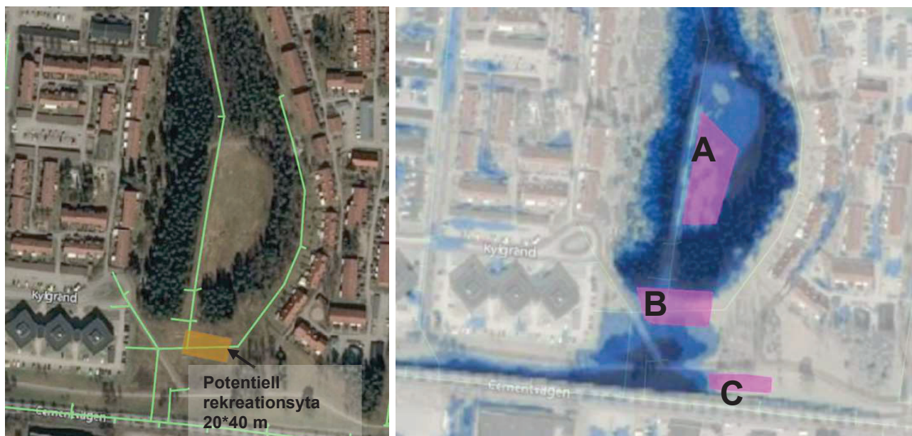
Figur 6. Vänster: Dagvattenledningar i gröna linjer som korsar parkområdet. Orange yta visar ytbehovet för en rekreatiionsyta; Höger: Utifrån översvämningskarteringen är ytorna A-C olika delar av parken med potential för sänkning.
