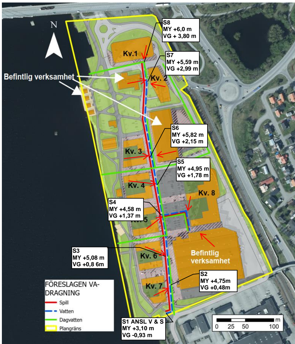
Figur 6 Föreslagen ledningssträckning för drick-, spill och dagvatten i området. Befintlig markyta (MY) och vattengång för spillvatten (VG) redovisas i punkterna S1-S8 längs med ledningssträckningen. Servislägen för drick- och spillvatten redovisas med röda pilar.
